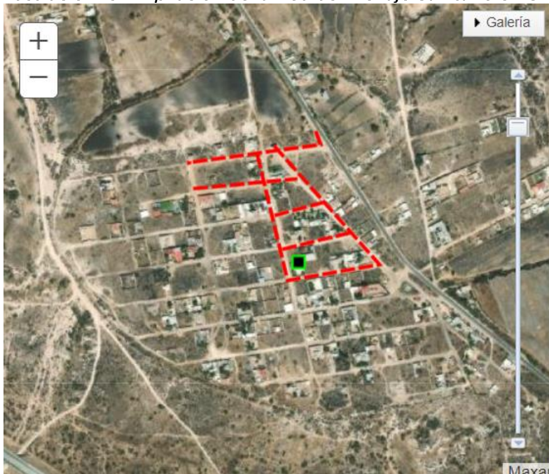
Ilustración 10 Ampliación de la Red de Drenaje Sanitario en Charco Blanco
